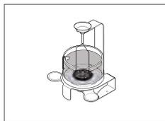
Kit para la determinación de densidades para los modelos de balanza Advanced y Standard con una legibilidad de 0,1 mg / 1 mg
