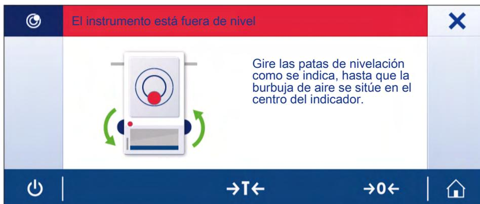
Después de seguir las instrucciones, el asistente de nivelación mostrará los siguientes pasos. Complete todos los pasos hasta que la balanza esté nivelada.
