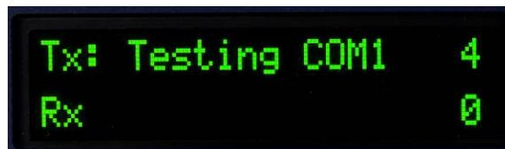
**Abbildung 4-3: Anzeige eines seriellen Tests**
