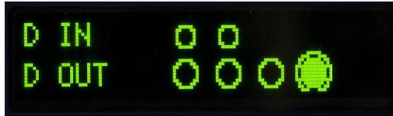
**Abbildung 4-6: Bildschirm „Diskreter I/O-Test“, ein Ausgang aktiv**
