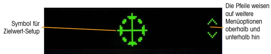
**Abbildung 2-2: Display im Bedieneringabemodus, Zielwertsymbol angezeigt**
