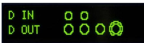
**Abbildung 3-19: Diskrete I/O-Test-Anzeige, Ausgang aktiv (unten)**
